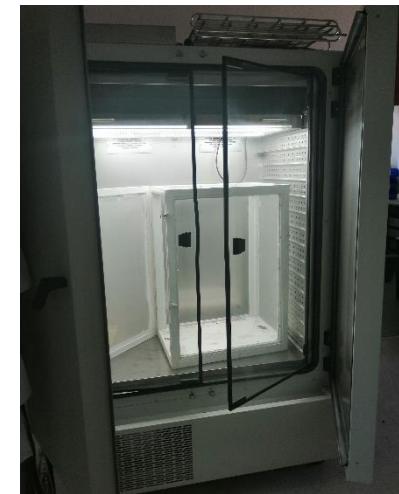
Armoire climatique BINDER pour essais de transmission (T°C = [20 ; 30]°C, HR = 70±10%, ventilation = 10%)
